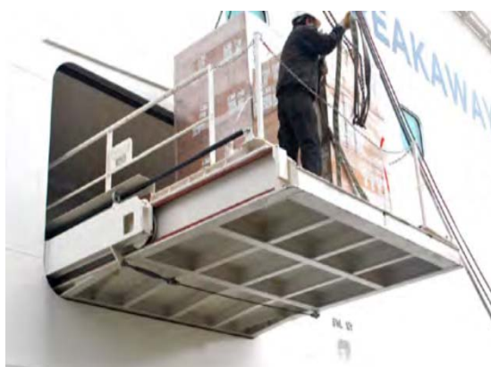
■ Loading Platform 装载平台
