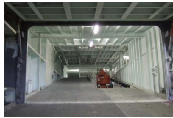
■ Bulkhead Door 舱壁门
